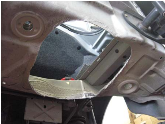
Ausschnitt Bodenblech, weil der Batteriekasten in das Reserverad hineinragt
