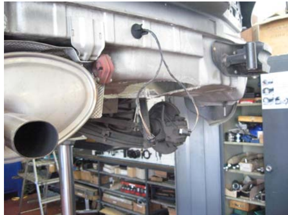
Ausschnitt Bodenblech, weil der Batteriekasten in das Reserverad hineinragt
