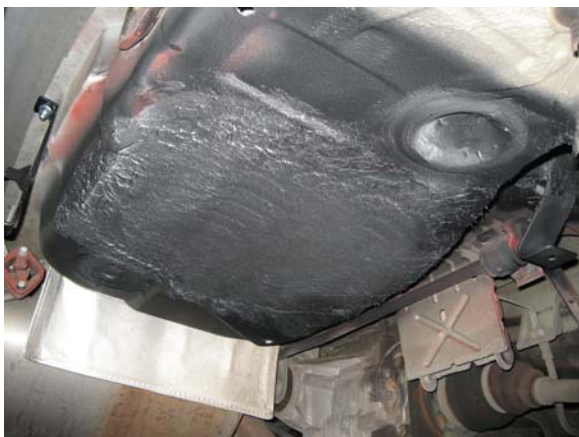
neue Bodenplatte und Batteriehalterung
