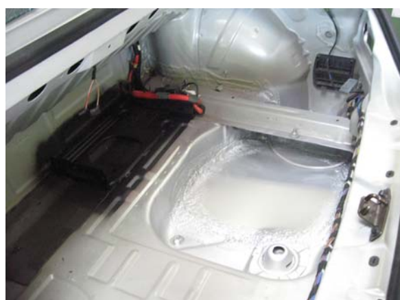
neue Bodenplatte und Batteriehalterung
