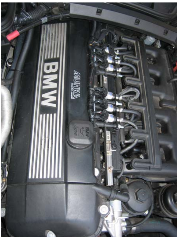
Steuerventile auf Motorblock
