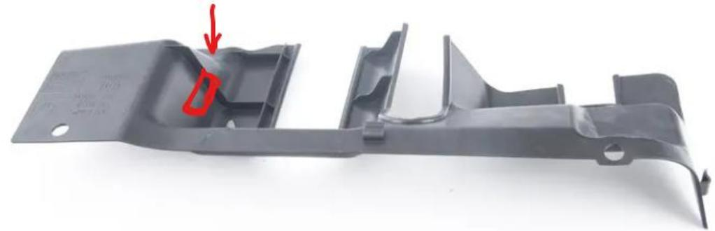
Zum lösen der Buchse den Rahmen in Pfeilrichtung schieben und dann den Stecker nach oben aushebeln.
