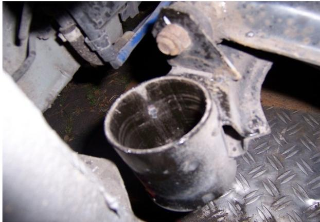
→ Neue Lager „einpressen“. Wichtig: Hierbei auf die Richtige Einbaulage achten. Der Lagersitz hat kleine „Führungsnippel“. Im neuen Lager sind Nuten, die bitte über die „Führungsnippel“ setzen und dann einpressen. ( kein Fett o.ä. zum Einpressen verwenden, Lagersitze und Lager müssen fett- und ölfrei sein! )
