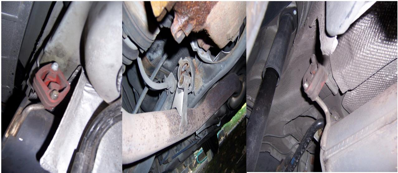
**Tipp:** Um das Herausdrücken der roten Auspuffgummis zu erleichtern ein wenig Silikonspray verwenden ( Keine Öle, die machen das auf Dauer Gummi spröde )
