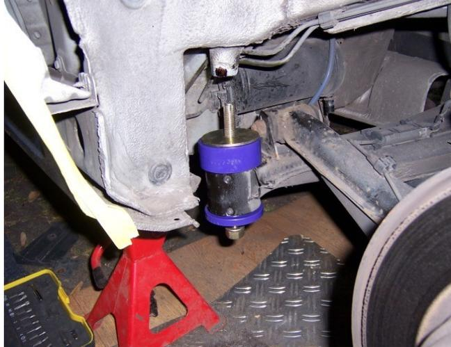
→ Jetzt wird die komplette Achse möglichst gleichmäßig wieder angehoben bis sich das Differentiallager wieder verschrauben lässt. Nun sitzen die Lager eigentlich schon ziemlich gut, aber der metallische Lagerkern muss noch eingeschlagen werden. Hierzu einen Schonhammer verwenden oder mit einem Schlagklotz arbeiten. Den Lagerkern plan zum Lager einschlagen.
