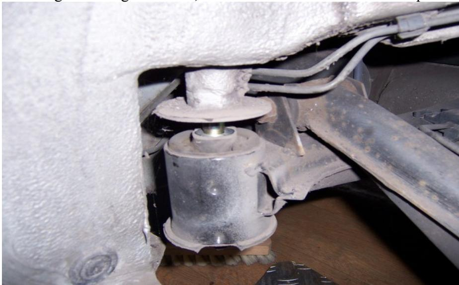
→ Ich habe festgestellt, dass man die Achse mit montierten Bremsleitungen nicht weit genug über die Bolzen absenken lassen kann. Da die alten Bolzen nicht mehr verwendet werden, habe ich diese mit einer kleinen Metallbügelsäge knapp unterhalb des Sechskants abgesägt.
