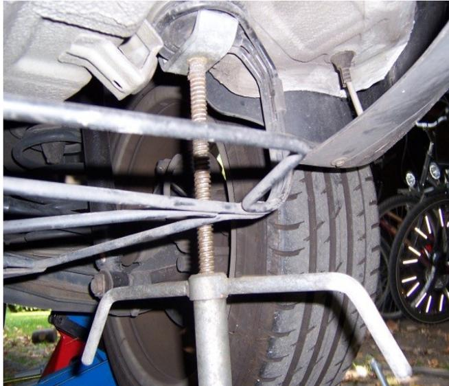
→ Jetzt werden die Räder sowie die Steinschlagschutzbleche vor den Tonnenlagern demontiert
