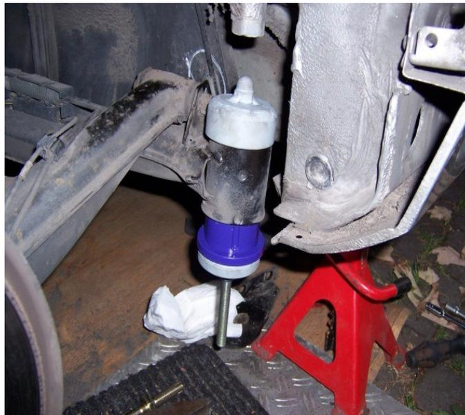
→ Sind die Lager nun drin kann der Lagerdeckel aufgelegt werden und die neuen Bolzen( inkl. Unterlegscheibe ) werden mit der Karosse verschraubt.
