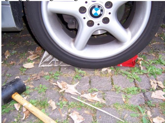
→ Nun fangen wir an geeignete Ansatzpunkte für den Wagenheber zu suchen. Ich habe die alten Tonnenlager gewählt. Durch den hervorstehenden Bolzen und die vorhandenen Löcher in meinen Wagenhebern war sogar eine gewisse Sicherheit gegen Verrutschen gewährleistet. Es kann auch unter dem Differential oder direkt an der Achse angesetzt werden. Dazu aber bitte einen Wagenheber pro Seite nutzen und möglichst gleichzeitig Anheben.
