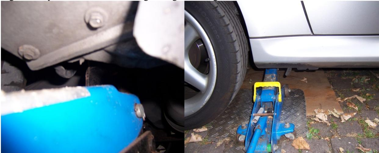
→ Ist der Wagen oben, Stützen an den originalen Wagenheberaufnahmen positionieren und den Wagen darauf vorsichtig ablassen
