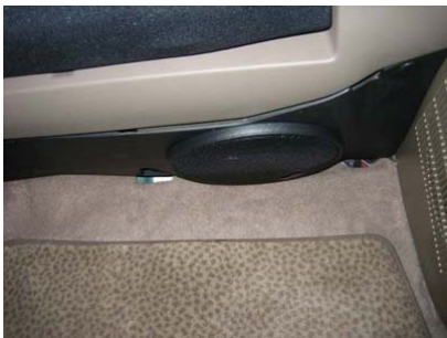
Lautsprechergitter als Luftaustritt im Fußraum
