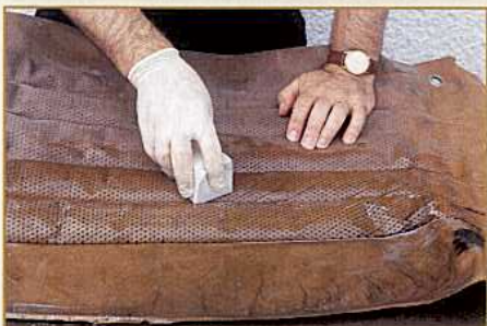
Die Behandlung mit dem Softener kann bei Bedarf ein paarmal wiederholt werden
