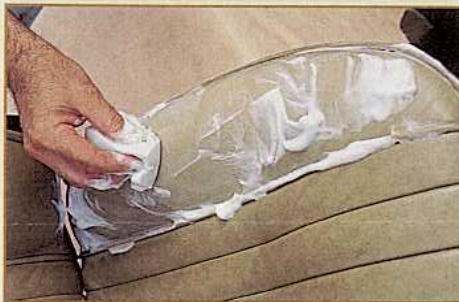
Damit sich keine Flecken bilden, sollten einzelne Flächen nach einander behandelt werden
