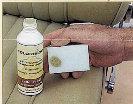
Die Tönung wird mit dem Schwamm aufgetragen. Sie egalisiert leichte bis mittlere Flecken
