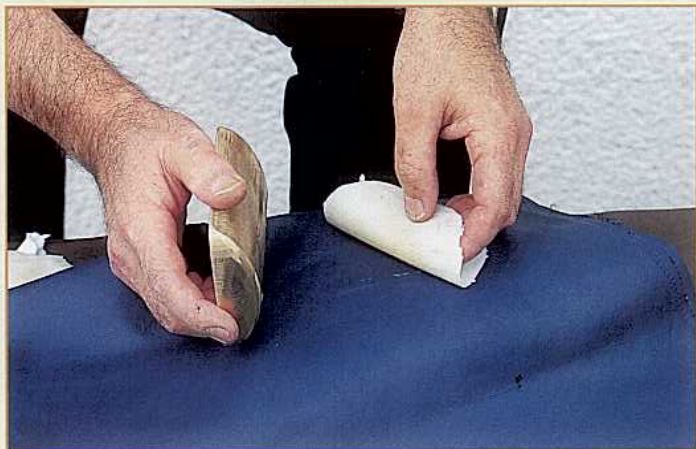
Weil die glatte Reparaturstelle auf dem genarbten Leder auffallen würde, erzeugt der Profi mit einer Kautschukplatte die passende Oberfläche
