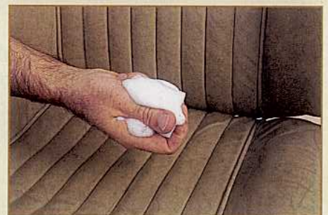
Durch Kneten des Schwamms entsteht ein sehr feiner Schaum. Auch hier gilt: Weniger ist mehr
