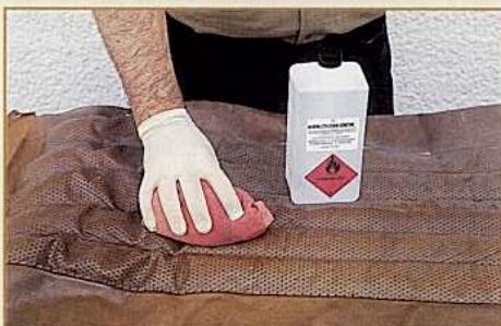
Wenn der Weichmacher richtig eingezogen ist, wird mit einem Lösungsmittel entfettet
