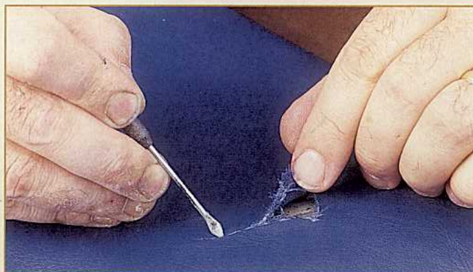
Zuerst wird der Riss geschlossen. Dabei hilft ein Zahnarztwerkzeug, feine Fasern so auszurichten, dass das Loch kaum noch auffällt
