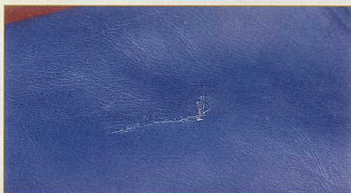
Die verklebte Beschädigung ist zwar schon kurze Zeit nach dem Trocknen wieder belastbar, aber immer noch deutlich zu erkennen
