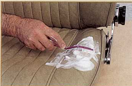
Auch aus tiefen Fältchen wird der Schmutz mit der Zahnbürste herausgeschrubbt
