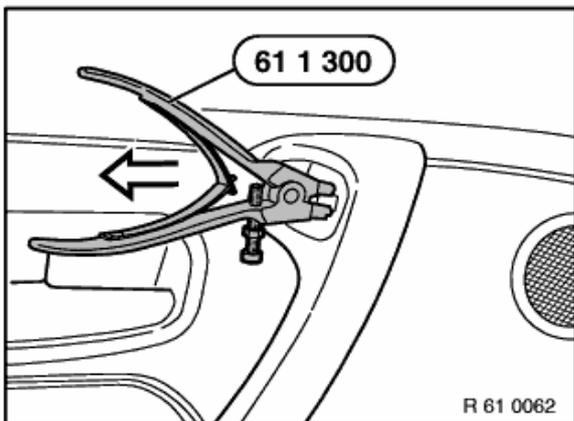
Spiegelschalter mit Spezialwerkzeug 61 1 300 herausziehen und Steckverbindung trennen.
