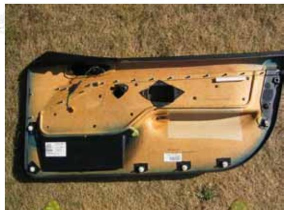
Türverkleidung nach oben herausziehen, dabei die Schachtabdeckleiste noch montiert belassen. Nicht am Türgriff ziehen – Beschädigungsgefahr! Am besten am hinteren Ende Anfangen:
