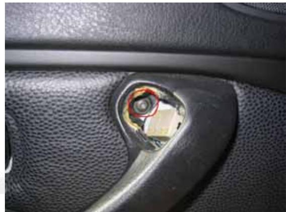
Befestigungsclips der Türverkleidung vorsichtig lösen – am besten mit einem Klammerheber:
