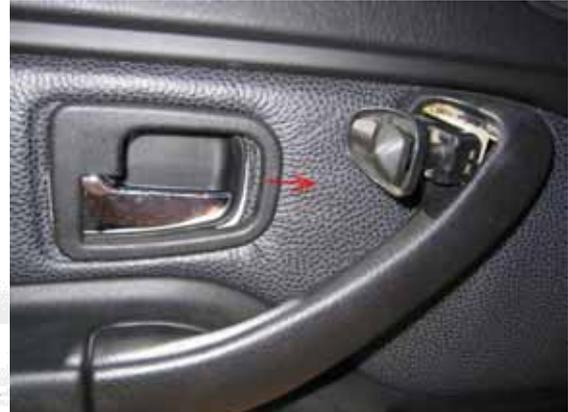
Schraube (Torx 20) die sich hinter der Außenspiegelbedieneinheit befindet, herausschrauben:
