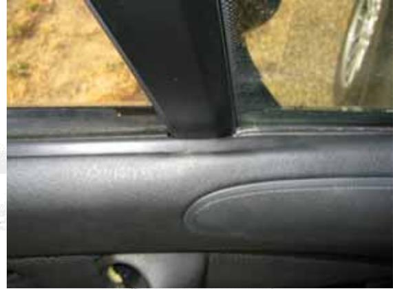
Die Türverkleidung selbst am besten am Ausschnitt für den Türöffner ausrichten:
