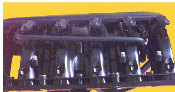
Abb. 10: Sauganlage M54
