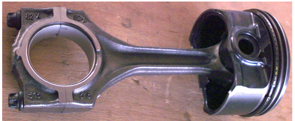
Abb. 6: Kolben mit Pleuel
