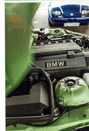
Oben: Die Kiemen sollen an den 507 erinnern. Links: 193 PS starker 2,8-Liter-Sechszylinder mit zwei obenliegenden Nockenwellen. Unten: Klassisches, gut ausgestattetes Dreier-Cockpit
