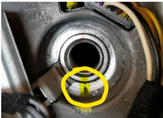
Bild 1: Markierung der Lenkradstellung und Steckverbindung der Wickelfeder
