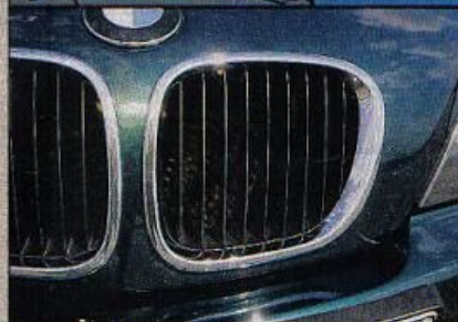
LACK AB 1: UM DIE NIERE PLATZTE DER DECKLACK WEG. HINZU KAMEN DIVERSE STEINSCHLAGSCHÄDEN
