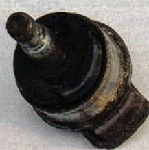
VERBRAUCHT: AUCH DIE BEIDEN SPURSTANGENKÖPFE ÜBERSTANDEN DIE 100 000 KM-DISTANZ NUR KNAPP
