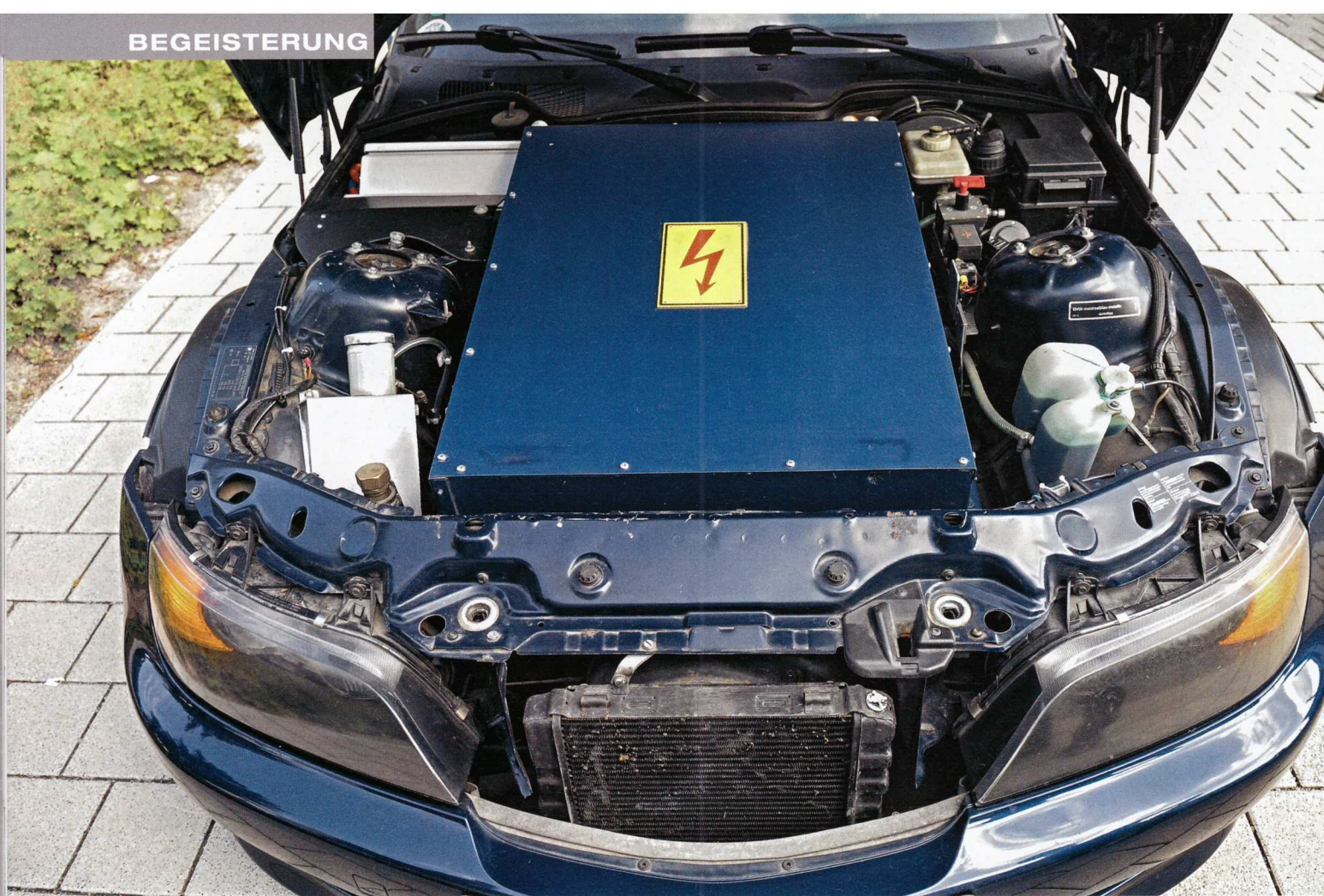
Für die maximal mögliche Größe des vorderen Batteriekastens wurde jeder halbe noch verfügbare Zentimeter im Motorraum genutzt. Vorn links der Behälter (mit Schraubdeckel) für rund anderthalb Liter Kraftstoff, mit der im Winter die Standheizung betrieben wird
