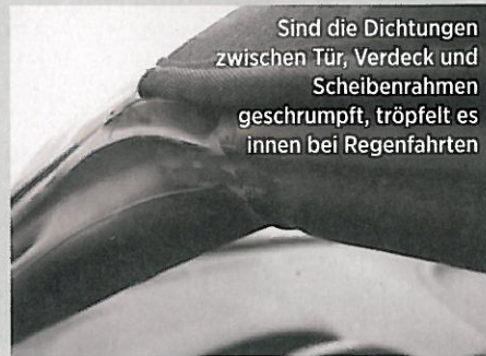
Hauptproblemzone des haltbaren Verdecks ist die Heckscheibe samt umlaufendem Keder
