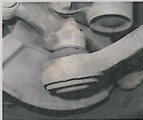
Die Traggelenke unterliegen normalem Verschleiß – sofern auch die Fahrweise normal ist
