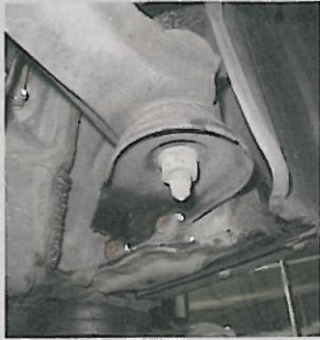
Lenkt das Heck mit, sind die berühmt-berüchtigten Tonnenlager hinüber
