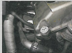
Typischer Ölnebel am Ventildeckel aufgrund mitlackierter Dichtflächen
