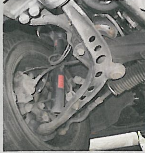
Die Querlenker sind nicht – wie damals schon oft – einteilig, Traggelenke und Buchsen...
