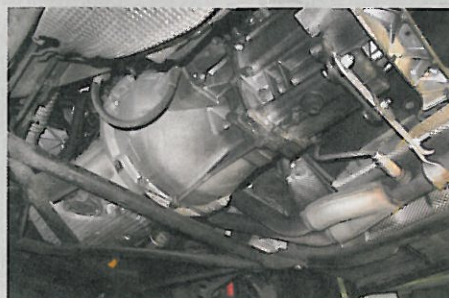
Technisch unproblematisch und haptisch ein Genuss: das Fünfgang-Schaltgetriebe
