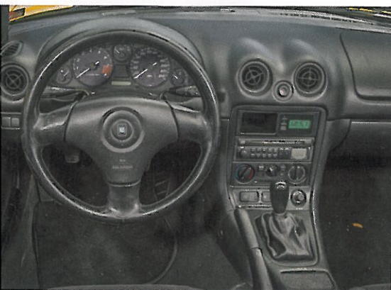
Fünf Uhren im Cockpit mit Nardi-Sportlenkrad. Der Doppelnocken (ein Freiläufer) entwickelt seine Leistung homogen und unaufgeregt
