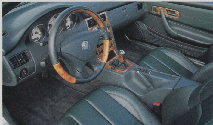
■ Der 218 PS starke 3,2-Liter-Motor ist der erste im SLK angebotene Sechszylinder. Neu ist auch das grazilere Lenkrad
