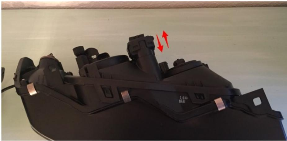
Das einrasten im Reflektor kann man kontrollieren indem man jetzt wieder mit einem Finger den Reflektor leicht vor und zurück bewegt. Der Motor muß diese Bewegung mit machen.
