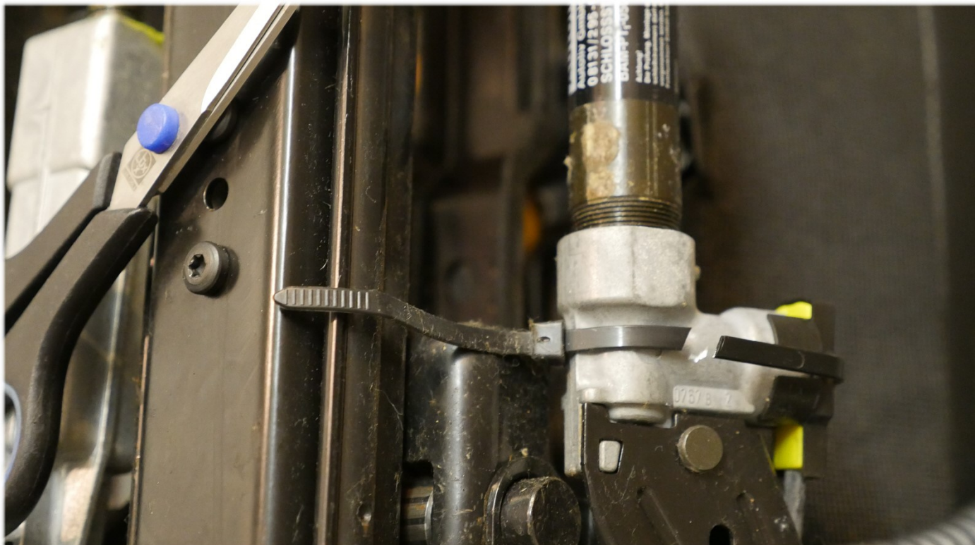
Kabelbinder des Gurtspanners entfernen
