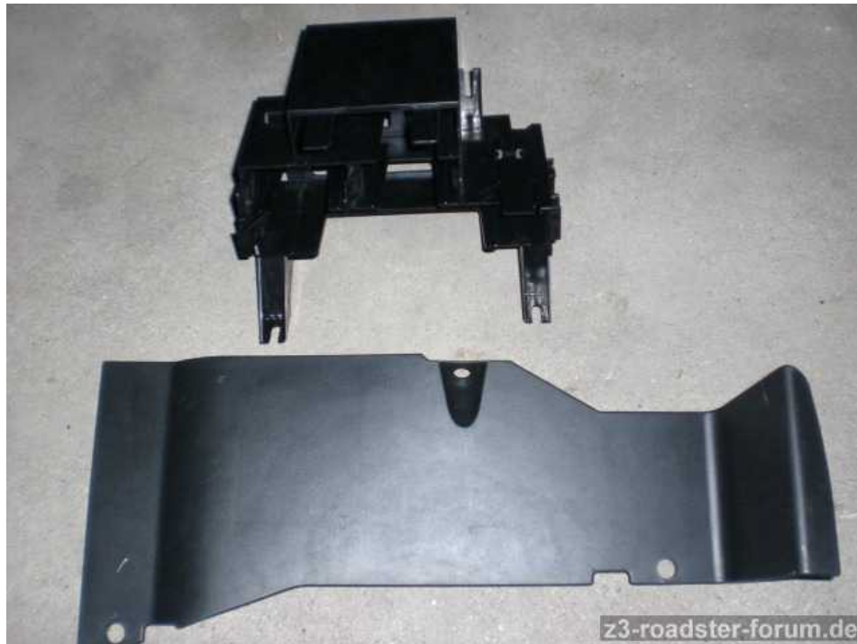
Oben: Steuergerätehalterung Unten: Blende (beide werden nicht mehr benötigt)
