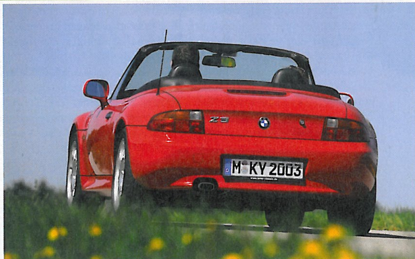
Das schmale Heck ist Erkennungsmerkmal der frühen Vierzylinder-Versionen. Reparaturfreundlich: Bis auf den Windlauf sind sämtliche Blechteile geschraubt
