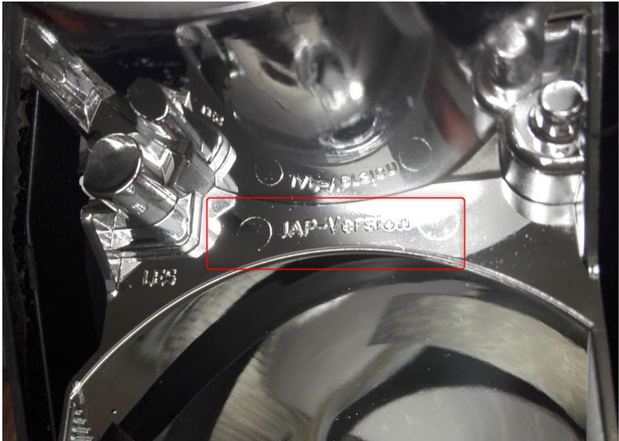
Ein Rechtslenker (RHD) Reflektor mit der Einprägung "JAP-Version".
