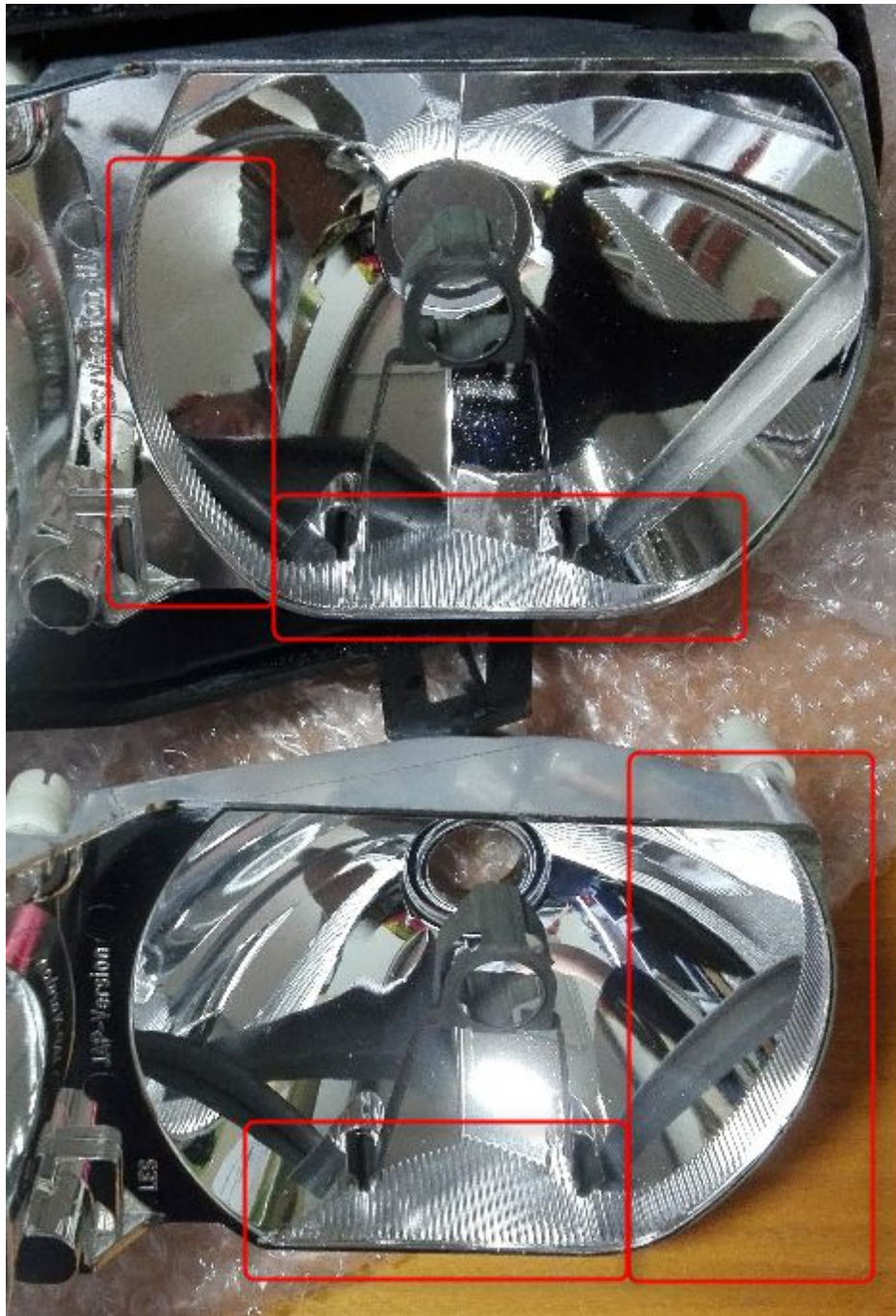
Unten der RHD Reflektor der Fahrerseite mit den Rillen an der Aussenseite. Oben ein ES/Version H7 LHD Reflektor.
