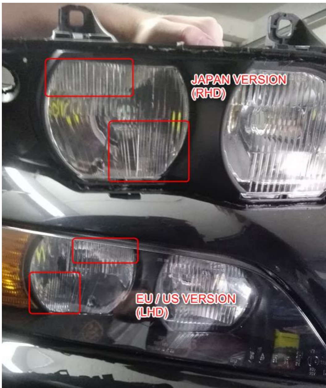
Oben ein RHD Scheinwerfer ohne Schutzscheibe. Unten ein LHD Scheinwerfer. Erkennbar: Die längsgerichteten Zylinderlinsen in der Streuscheibe sind in Ihrer Position vertauscht.
