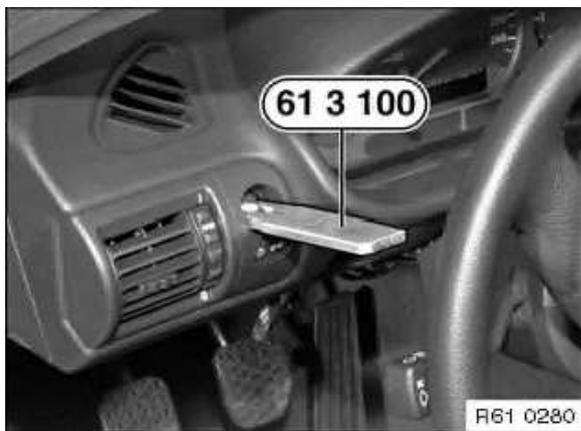
Halteklammern mit Spezialwerkzeug 61 3 100
