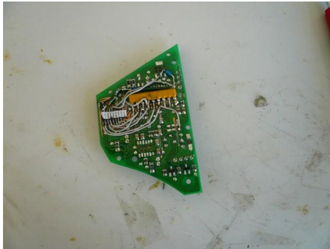
Die neuen Teile in eingelötetem Zustand.
