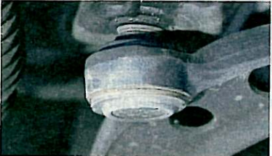
Schnell verschlissen: Die Traglenke der Vorderachse halten nicht lange
