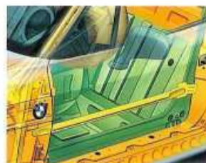
Schützt bei einer seitlichen Kollision: Seitenaufprallschutz in den Türen.
