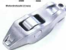
Rollenschlepphebel minimieren Reibung zwischen rotierenden Nocken und Übertragungshebeln.
