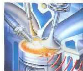
Mit zylinderselektiver Klopfregelung stellt sich der Motor auf Kraftstoff unterschiedlicher Oktanzahl ein.
