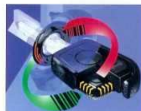
Elektronische Wegfahrsperre (EWS): Eine doppeltelektronische Codierung im Schlüssel schützt vor unbefugtem Starten.
