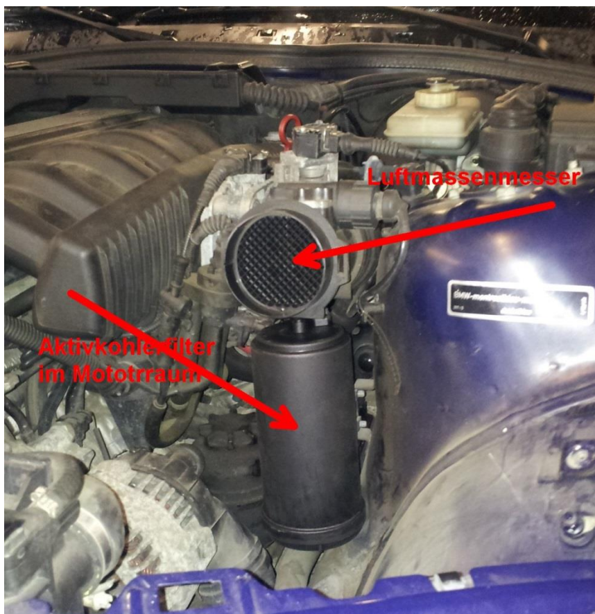
Bild 18: Einbauposition AKF bei VFL-Modellen im Motorraum unter dem Ansaugluftfilter ( hier wird nicht so viel Schmutz angesaugt)
