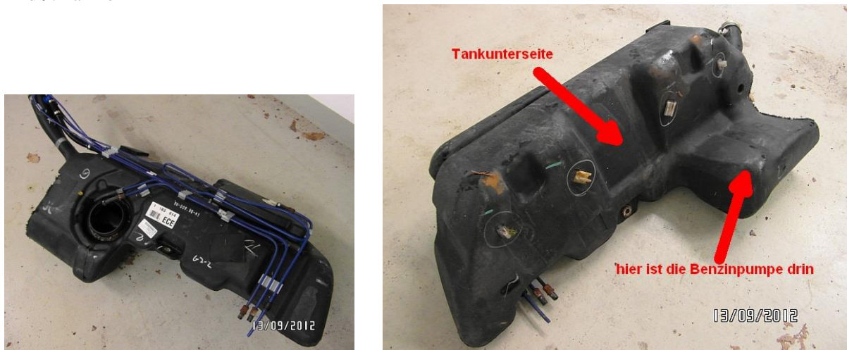
Bild 10: Rückseite mit demontiertem Schwimmer und Messwertaufnehmer
