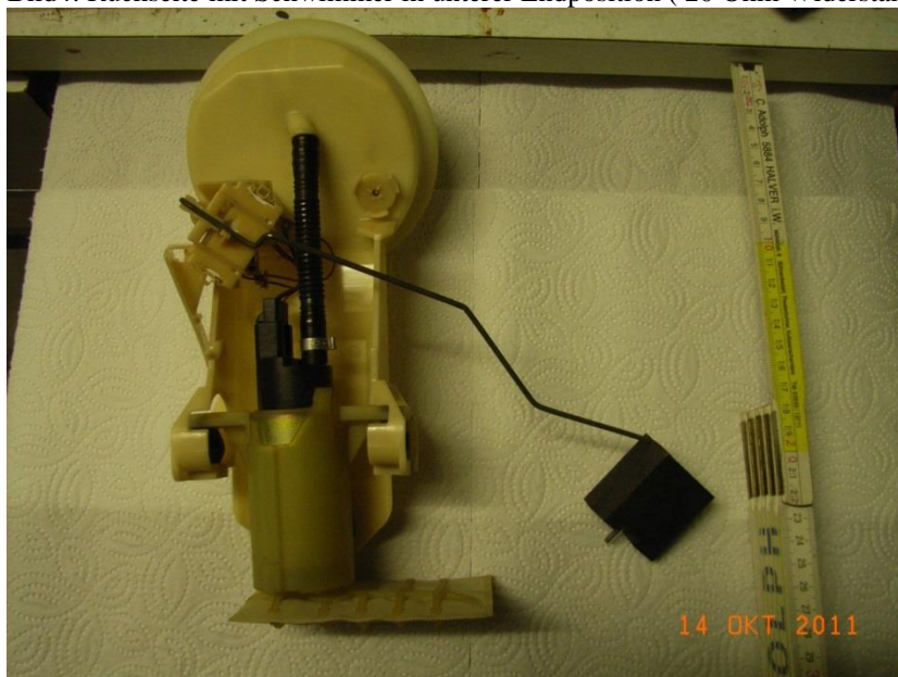
Bild4: Rückseite mit Schwimmer in unterer Endposition ( 20 Ohm Widerstand)
