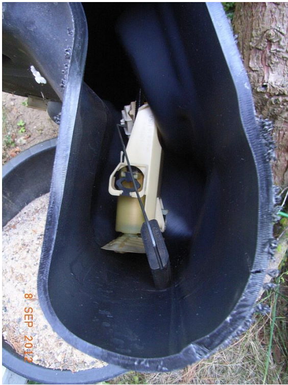
Bild 12: Aufgeschnittener Aktivkohlefilter
