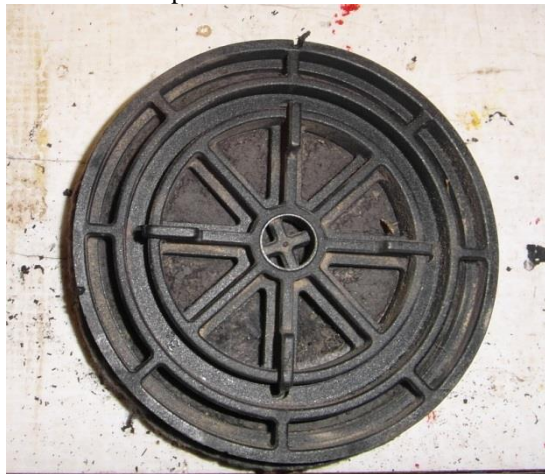
Bild 14: Verstopfter Filter aus dem AKF
