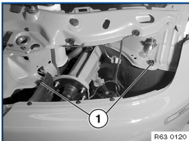
Zum Einstellen des unteren Spaltes Scheinwerfer wieder ausbauen. Spreiznieten (1) verdrehen und Scheinwerfer wieder einbauen.
