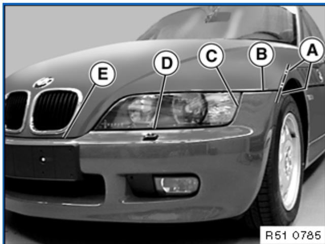
Beim Scheinwerfereinbau werden alle Schrauben zunächst bis zum letzten Gewindegang eingedreht. Dabei die Spreiznieten gegenhalten.
